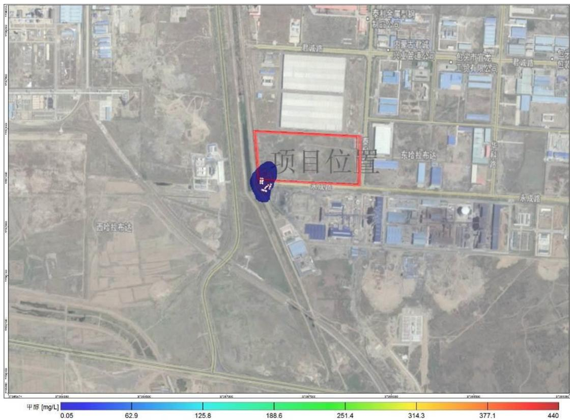
图 6.2-20 污染物在潜水层运移 1000d 时运移图
