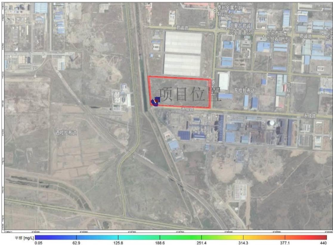
图 6.2-18 污染物在潜水层运移 30d 时运移图
